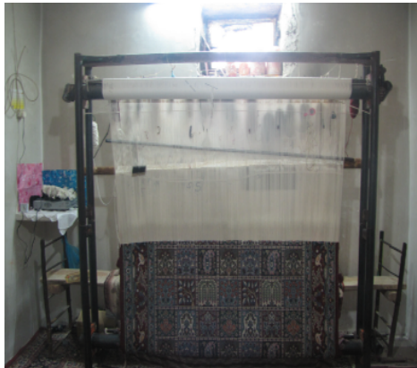
شکل ۳- دار قالیبافی-عمودی با پایه فلزی
